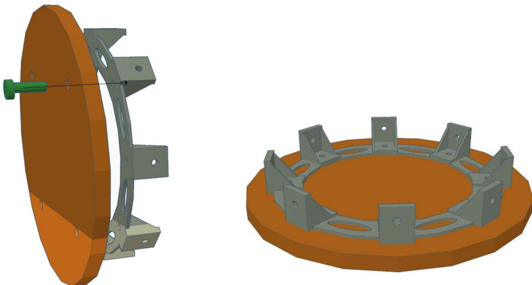
3.2 – Fixer les poteaux sur le connecteur du bas – 8 vis
