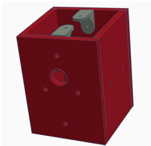
3.4 – Fixer enfin le toit et le dessous D – 2 vis par face
